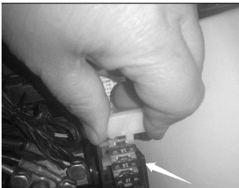
**Précaution:** Lorsque vous remplacez un fusible grillé, veillez à utiliser un fusible ayant le bon ampérage. Il est strictement interdit de remplacer un fusible grillé par des matériaux comme du papier d'aluminium ou des fils métalliques. Si le fusible de rechange grille à nouveau en peu de temps, cela peut indiquer un problème électrique plus grave. Dans ce cas, contactez immédiatement votre concessionnaire.
