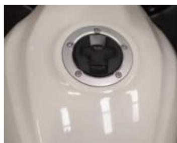
Pour ouvrir le capot du réservoir de carburant, insérez la clé et tournez-la dans le sens des aiguilles d'une montre de 90 degrés, puis tirez le capot avec la clé. Pour refermer le capot, insérez la clé, tournez-la contre le sens des aiguilles d'une montre de 90 degrés, appuyez fermement sur le capot, puis retirez la clé.
