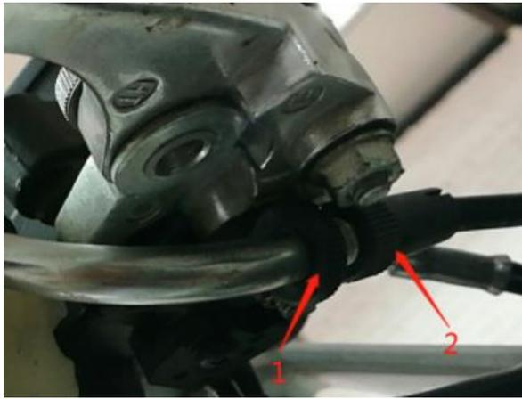
① écrou de verrouillage ② régulateur
