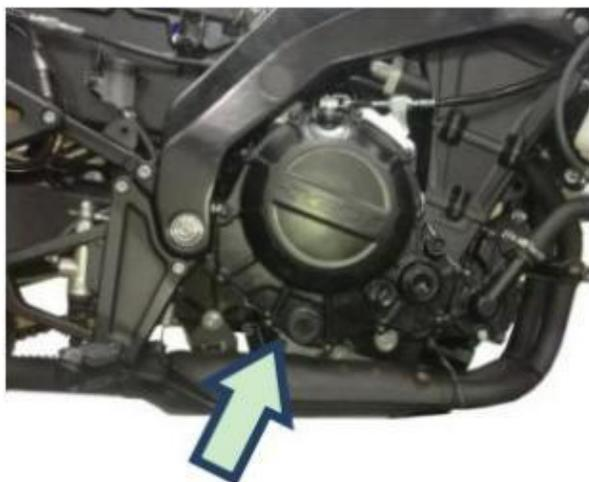
**Attention: Si le niveau d'huile est trop bas, un voyant d'alerte de niveau d'huile s'allume sur le tableau de bord, ce qui empêche le démarrage du moteur. Ne jamais faire fonctionner le moteur si le niveau d'huile est trop bas. Ne dépassez pas la limite supérieure du niveau d'huile indiquée sur le hublot.**
