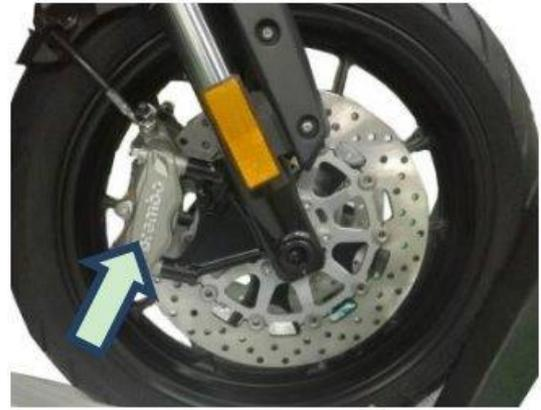
Pour vérifier l'usure des plaquettes de frein avant, vérifiez si elles ont atteint la limite d'usure marquée. Si les plaquettes ont dépassé ce marguage, elles doivent être remplacées.
