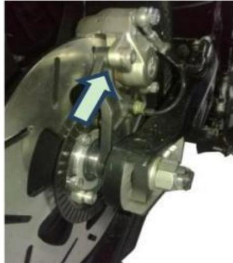
Pour vérifier l'usure des plaquettes de frein arrière, vérifiez si elles ont atteint la limite d'usure marquée. Si elles dépassent ce marguage, il faut les remplacer.
